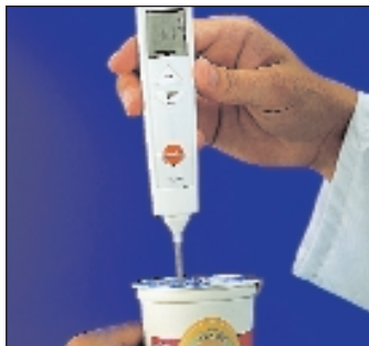
Misura della temperatura interna con terminale sottile e robusto
